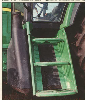
Trinene ud i kabinen er skridtsikre og afskærmet fra baghjulene. Bemærk den store tank, som er let at fyldes.
