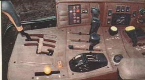
Stort set samtlige betjeningsgreb er placeret i konsollen til højre for føreren. Forrest ses den lange gearstang, som aktiverer parkeringsbremsen, når den føres over i kullissen ind mod føreren.
