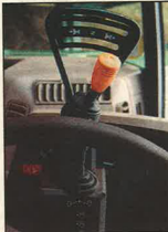
Kontakten til vendegæret er nu flyttet op under rattet, hvor den let kan nås med venstre hånds fingerspidser.
