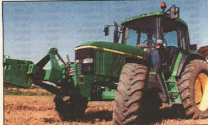
Den affjedrede forsækel er altid aktiv, og ved hurtig kørsel på ujævn vej giver det en god komfort og stabilitet.
