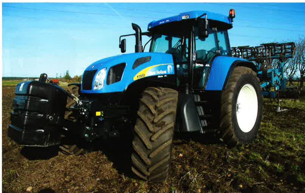
T7550 er den største model i T7500-serien. Traktoren har trinløs transmission og yder 216 hestekræfter ved maksimal belastning med power boost. Den er let at køre og komforten er på nogle områder helt i top. Andre steder kniber det lidt.
