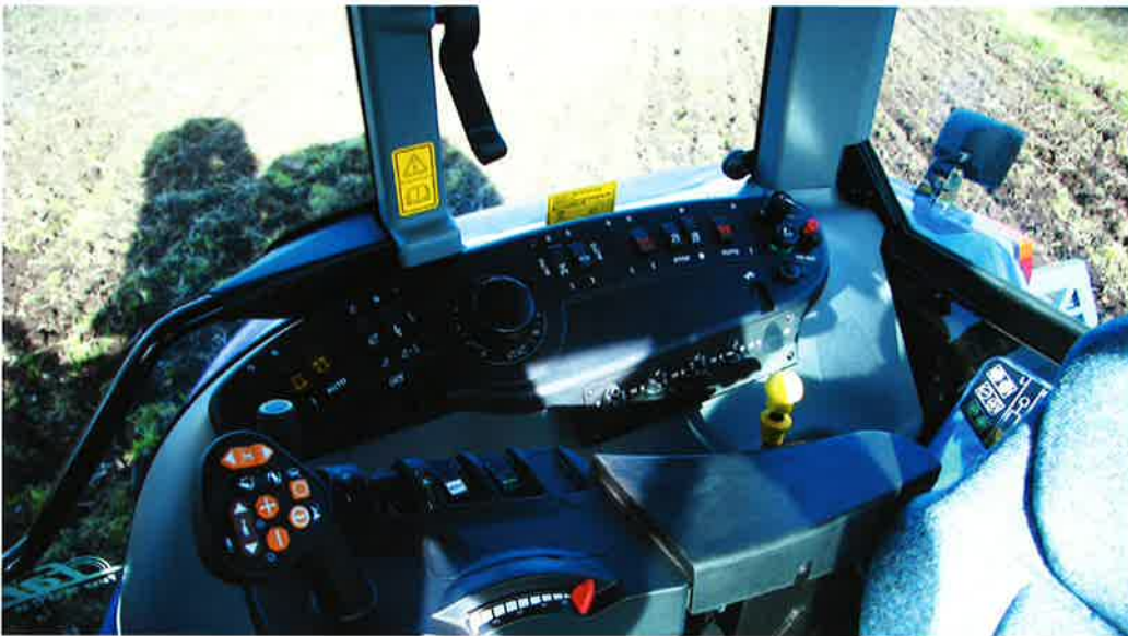
Kabine med multicontrolleren. På håndtaget kan man styre vendegear, fremkørselshastighed, cruisekontrol, et af de hydrauliske udtag samt blandt andet foragerautomatikken, som traktoren også er i besiddelse af.
