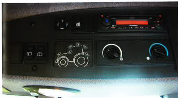
Betjeningen af aircondition-anlægget foregår i loftet.
