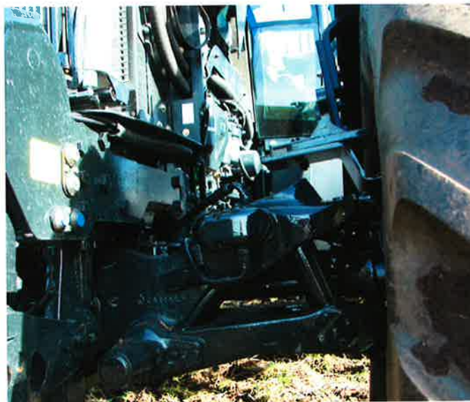
Traktoren har uafhængig affjedret foraksel, som klarer sig fremragende i sammenspil med den affjedrede kabine. Ulempen er de forholdsvis mange smørenipler på forakslen.
