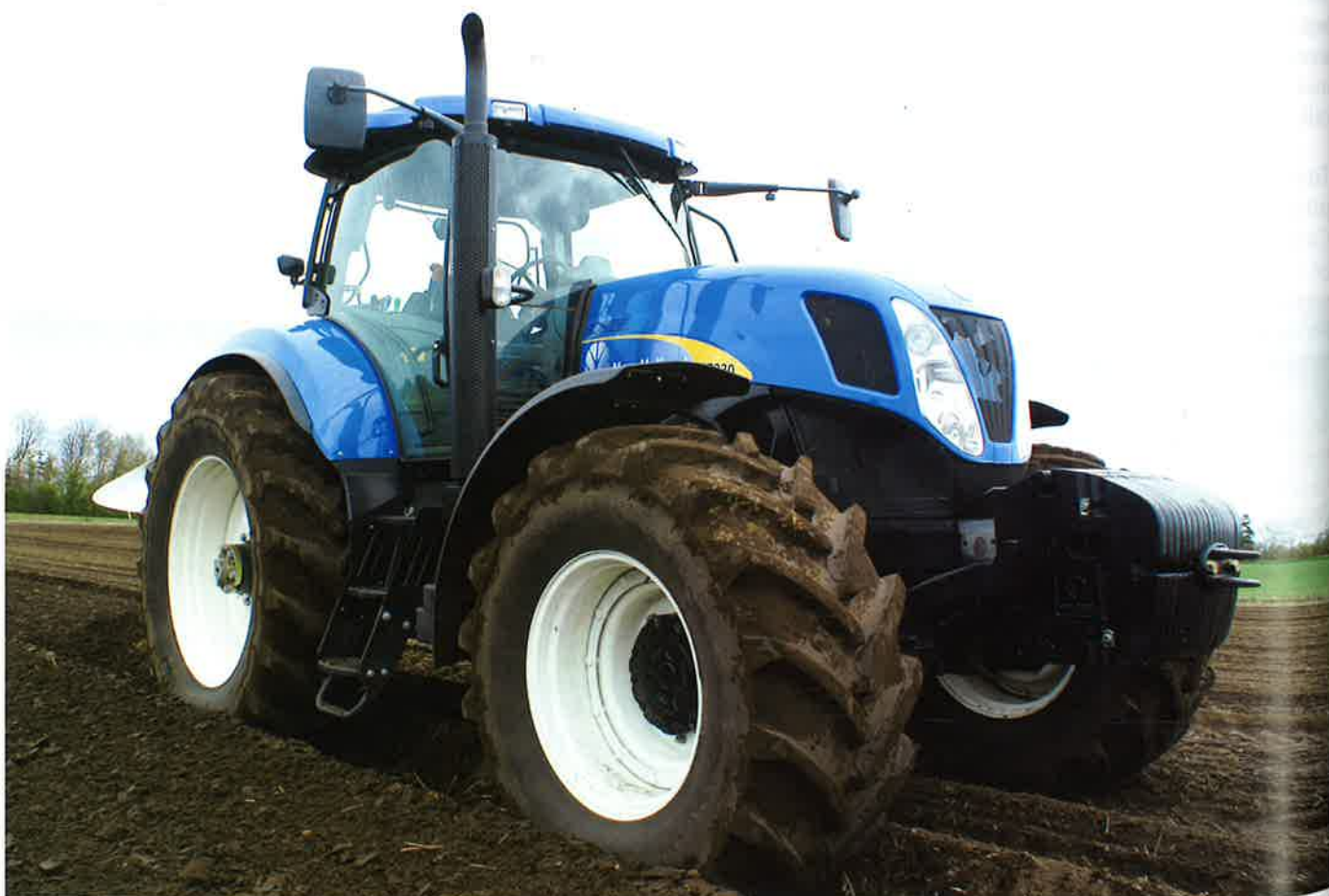
Den nye New Holland T7030 har en sej motor, som kan presses langt ned i omdrejninger uden at tabe pusten, og når der er ekstra brug for effekt til enten transportkørsel eller arbejde med PTO-drevne redskaber, øger Power Management effekten til 215 heste.
