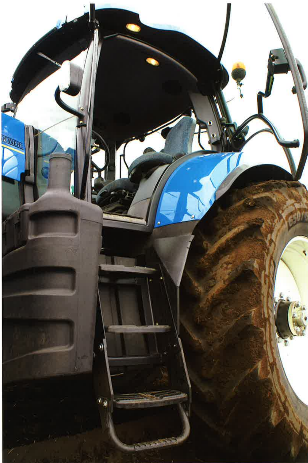
Kabine på T7030 er udført med kun fire stolper og to meget brede døre. Specielt fra venstre side er der meget fin adgang til kabinen, og trinene op i kabine er både skridsikre og afskærmede ind mod baghjulet.
