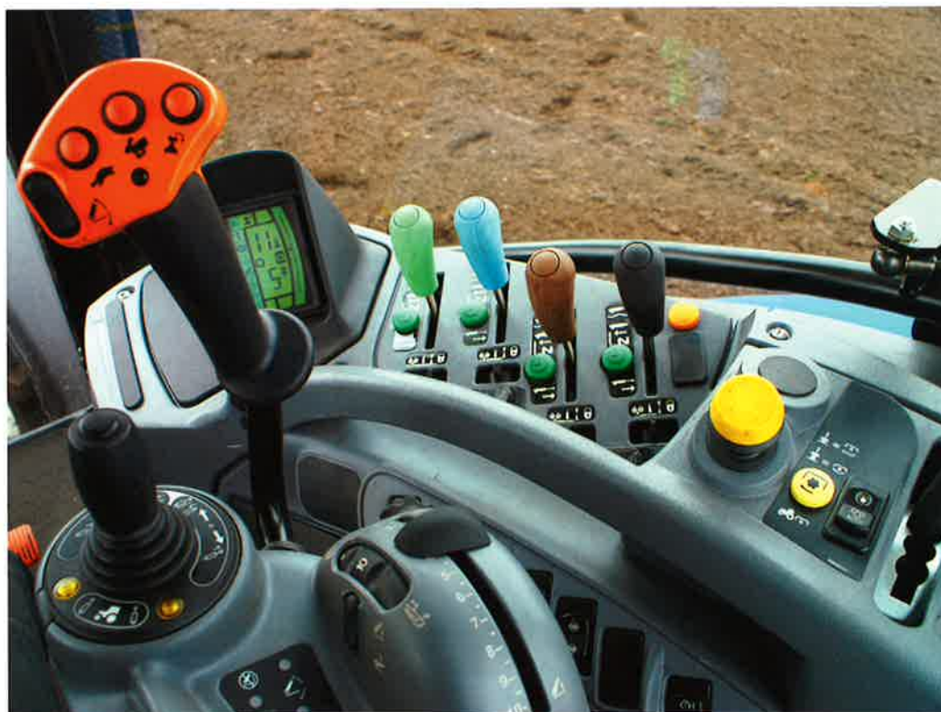
Såvel liftens som de fire hydrauliske fjernudtag betjenes elektronisk og kan betjenes via kontakter og joystick i sædets armlæn. De fire hydraulikventiler kan desuden betjenes med de fire håndtag i kontrolpanelet til højre for føreren.
