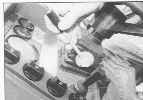
Rattet kan vippes, men først skal det løses med dette værktøj. Det er et besværligt, så rattet vil sandsynligvis ikke blive justeret særlig tit.
