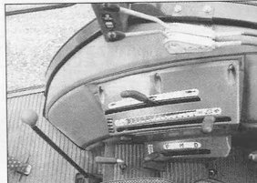
Betjeningspanelet i maskinens højre side. Øverst ses betjeningshåndtagene til den eksterne hydraulik. Bag hovedgearstangen ses gearstangen, der skal løfte op, når man skifter fra lavt til højt gear.
