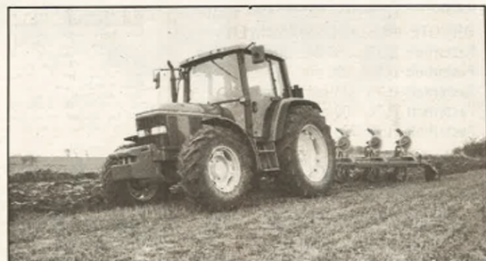
John Deere har rykket førerhuset meget langt frem på 6000-serien. Det giver, sammen med udstigningsrets placering ved højre kabinestolpe, et meget fint udsyn fremad.
