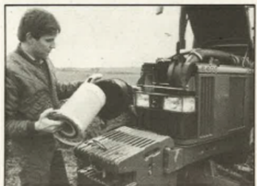
Dette er bare godtgjort! Når luftfilteret skal renses, skal man ikke baksæ med værktøj eller genstridige fingerskruer. Et enkelt greb fjerner hele filterhuset, som sammen med filteret kan rengøres for snavs.
