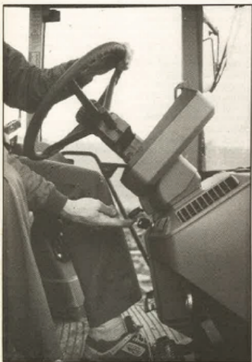
Kabinen er velindrettet, og en af fordelene er rattet, der kan vippe og indstilles i længderetningen. Når det vippes, vipper hele instrumentbordet med, så føreren altid har optimalt overblik over instrumenterne.
