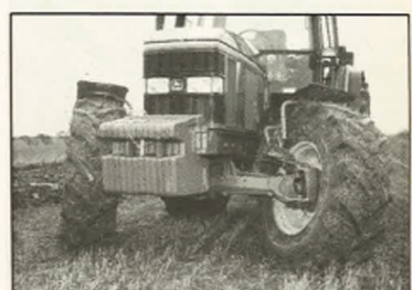
John Deere bruger ZF foraksler med en castervinkel på 12° - det medfører, at forhjulene lægger sig en smule ned, når man drejer. Dette, sammen med en drejevinkel på 52°, giver en venderradius på kun 4,47 m.
