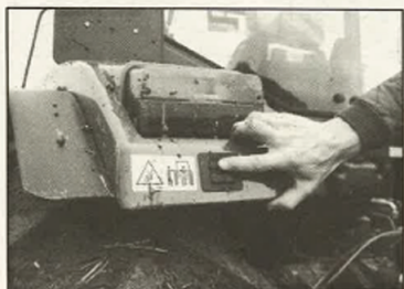
Traktoren er forsynet med elektronisk liftregulering. Ved til- og frakobling af redskaber kan liften reguleres via trykknapper på begge bagskærme. Når disse kontakter benyttes, foregår løfte- og sænkebevægelserne af sikkerhedsmæssige grunde meget langsomt.
