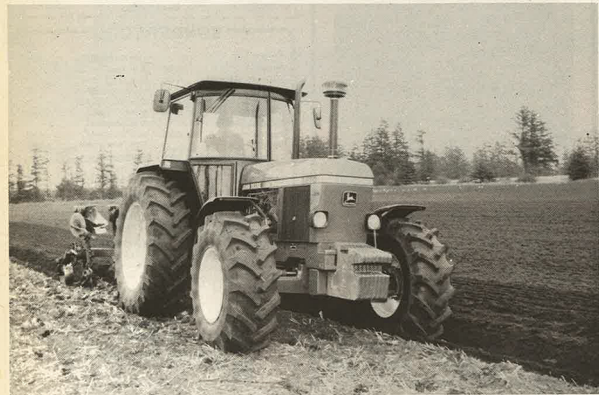
Fælles for 50-seriens motorer er en meget støj drejningsmomentstigning. Det resulterer i en konstant effekt selv ved lave motoromdrejninger.
