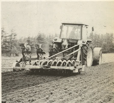
John Deere er udstyret med et »lukket center« hydrauliksystem. Dette bevirker, at der altid er fuld tryk på alle systemer.
