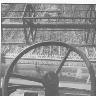
Udsynet er godt, hvilket ikke mindst skyldes den rundbuede frontude. Der er overblik over hele skærebordets bredde.
