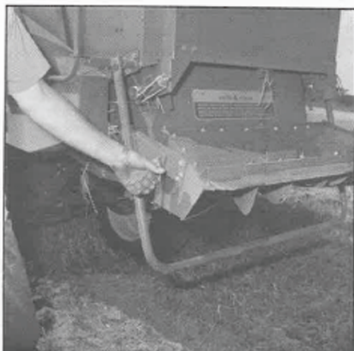
Snitteren er besværlig at til- og frakoble, ligesom spreddeplader skal justeres med nøgle.
