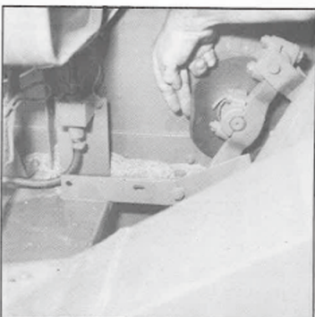
Her er en detalje, der ikke fungerer godt nok på mejetærskeren: Hvor soldopphængen er monteret på mejetærskerens, kommer kerner ud, trods gummiafdækning. Problemet er rettet på maskinen nu, men det kunne det jo have været gjort fra fabrikkens side!
