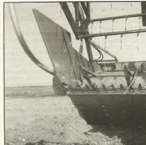
Skærebordet er forsynet med store slidplader, slæbesko, som gør det muligt at lade det følge jorden helt tæt. Det er en fordel i lave afgrøder som f.eks. ærter.
