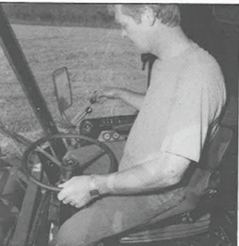
Rattet kan justeres, ligesom sædet kan indstilles til at spidre mere eller mindre alt efter pilotens vægt. En god, ergonomisk rigtig arbejdsplads.
