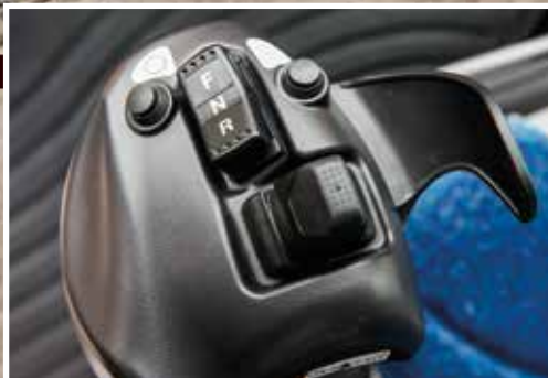
Joystick-styresystemet (ekstraustyr) giver exceptionelt effektiv styring.
